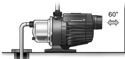
Fig. 3 Dégagement minimal derrière la pompe
