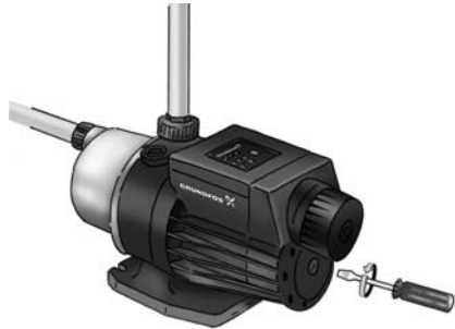
Fig. 17 Retirar el tapón de la cubierta posterior
